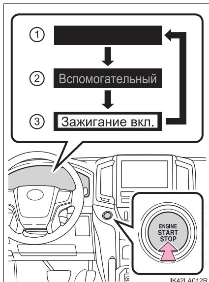
\*: Если при выключении двигателя рычаг управления трансмиссией находится в любом другом положении, кроме P, переключатель двигателя устанавливается в режим ACCESSORY, а не в режим выключения.
